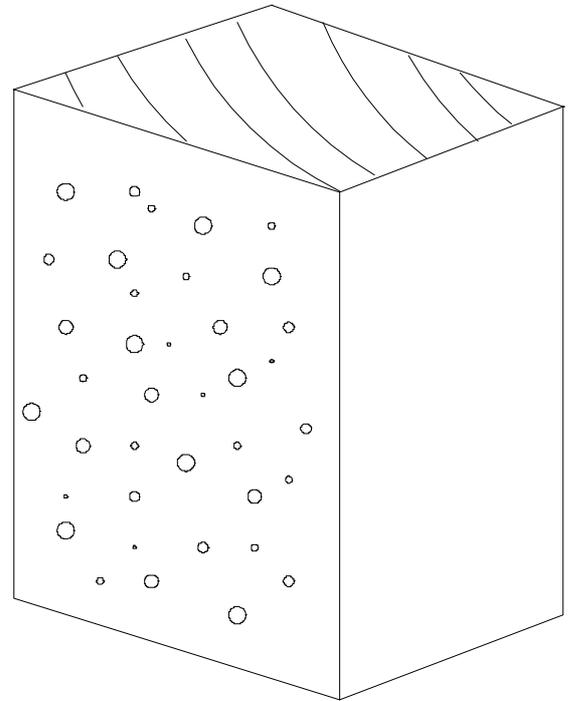
Für die Herstellung von Insektennisthölzern eignen sich vorzugsweise Hölzer aus Eiche, Buche oder Robinie. Daraus stellt man je nach dem zur Verfügung stehenden Material würfelförmige Stücke mit einer Kantenlänge von 10 bis 30 cm her, also etwa die Grösse eines Ziegelsteins. Die Tiefe des Holzstücks sollte gut 10 cm betragen. Geeignet sind natürlich auch komplette Stammabschnitte. Diese können ringsum eingebohrt werden und eignen sich für die Aufstellung im Garten.
